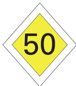
Figura 5. Señal ejecutiva de velocidad limitada. Fuente: RENFE
