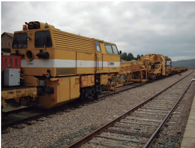
Imagen 2.23. Tren de renovación rápida (TRR). Fuente: COMSA
