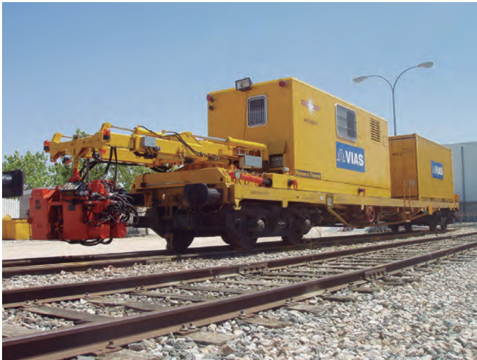
Imagen 2.27. Tren Soldadura Carril. Fuente: VIAS
