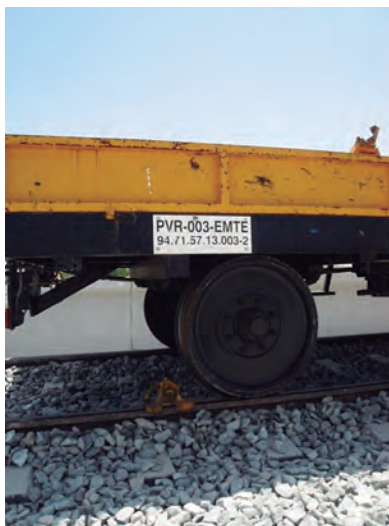
Imagen 5.9. Colocación de calces.
